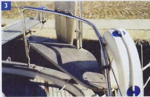
Foto 1 - In primo piano il tientibene di alluminio montato sulla cornice del paraspruzzi.
